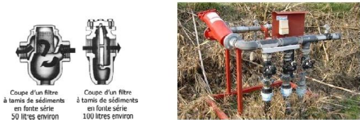
Figure 7: Schéma et photo des filtres à tamis
