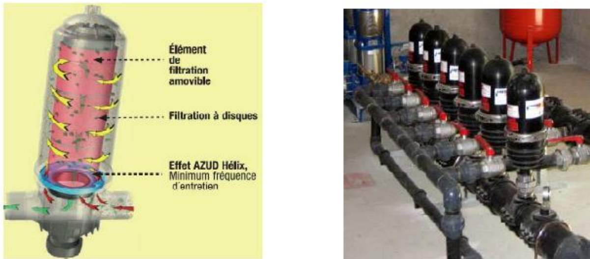
Figure 5: schéma et photo du filtre à disques
