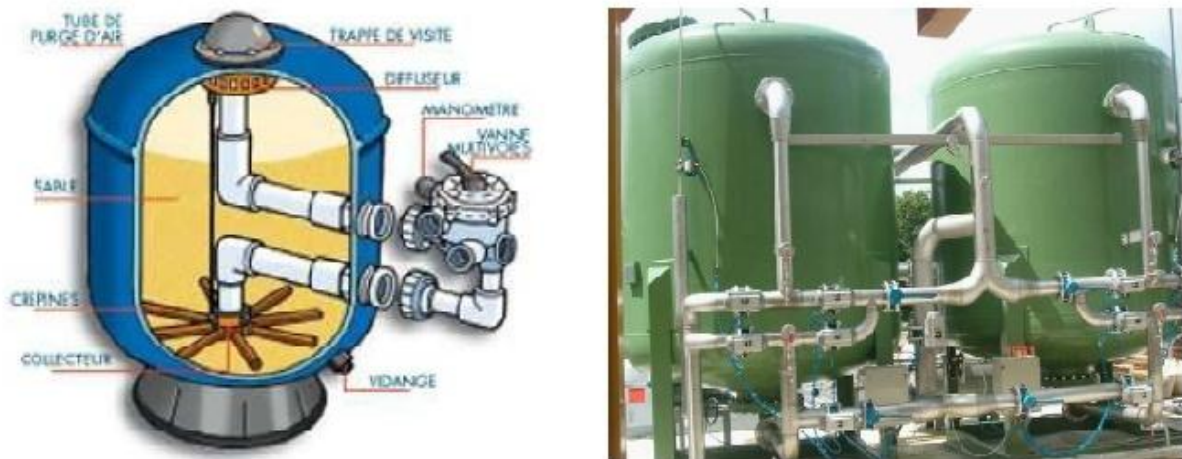
Figure 6: schéma et photo des filtres à sable
