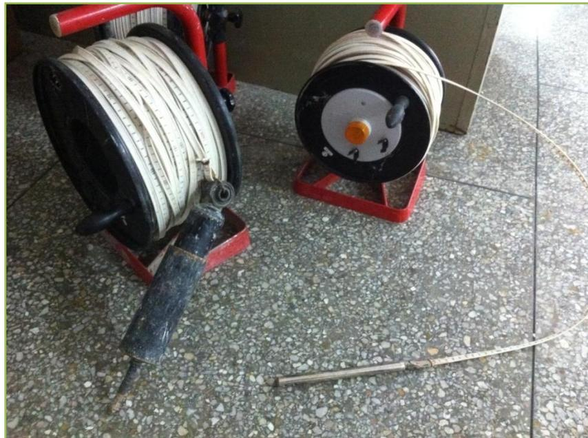
Figure 17: Les sondes des toisées, à droite une sonde qui détecte le niveau piézométrique, à gauche une qui détermine la profondeur du remblaiement.
