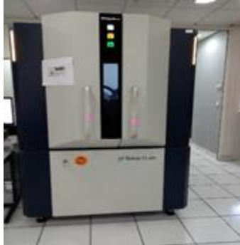
Figure 7 : Appareil utilisé pour la DRX au Centre d'Analyse et de Caractérisation (CAC)
