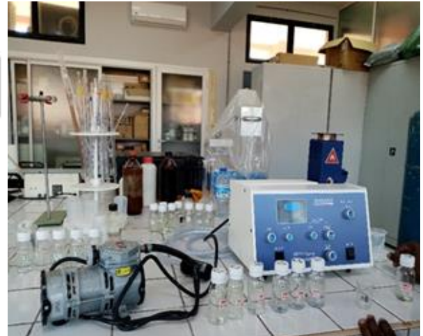
Figure 4 : Représentation schématique et photomètre utilisé pour déterminer les émissions des ions en sodium et potassium
