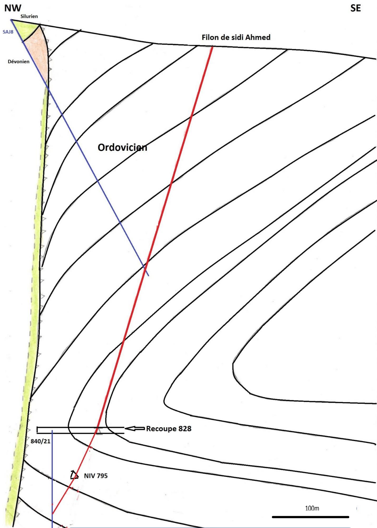
FIGURE 27 : CAS DE PLISSEMENT ANTÉ-CHARRIAGE (COUPE À L'EXTRÉMITÉ OUEST DE SIDI AHMED)
