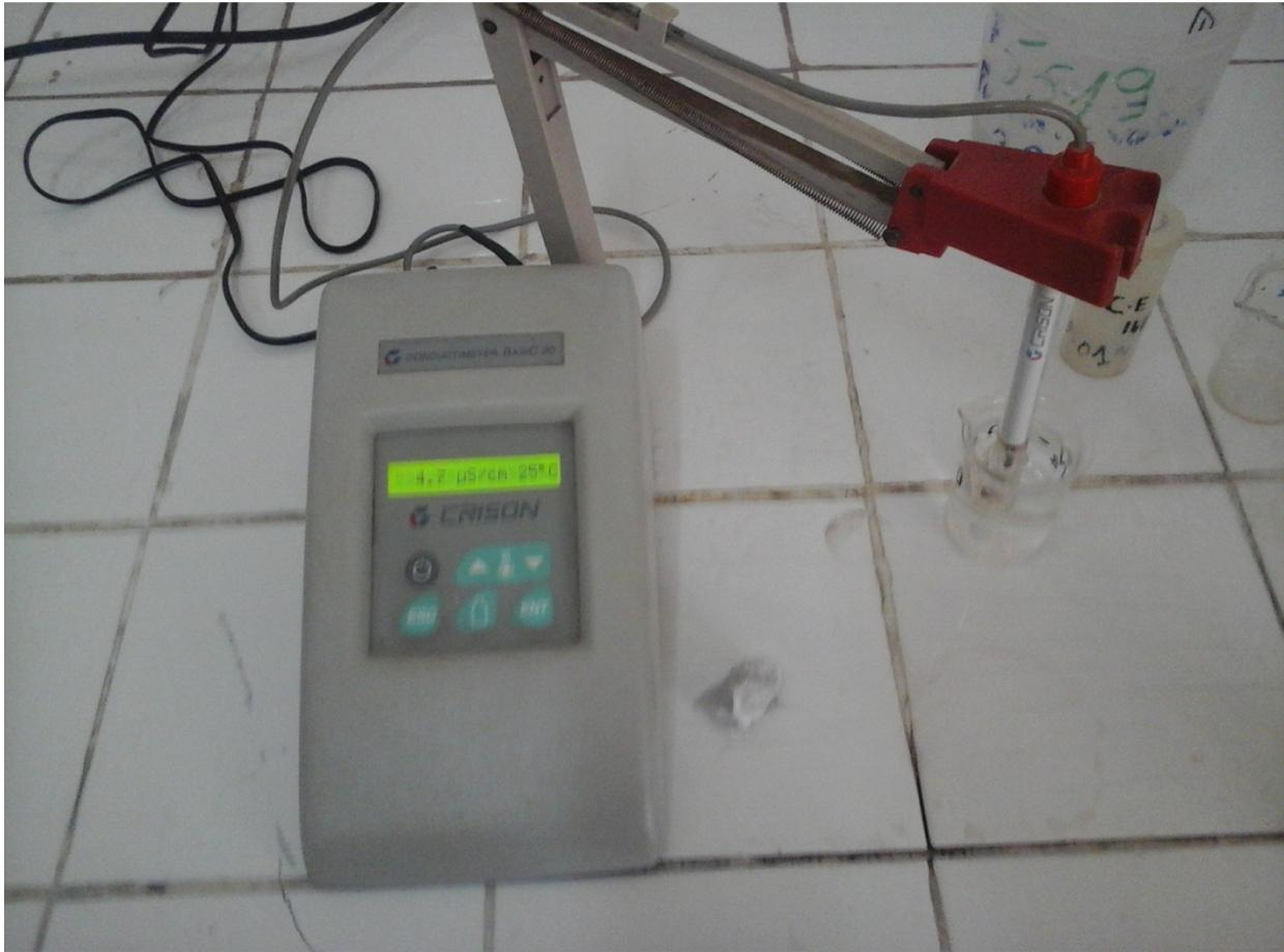
**Photo 6: Mesure de la conductivité de l'eau (Labo d'ORMVAH)**
