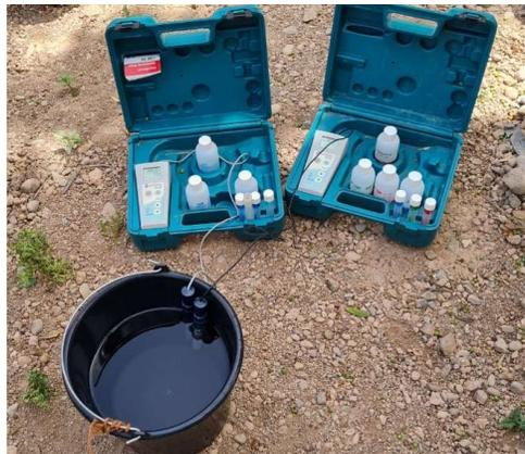
**Photo 12 : mesure de température, pH et conductivité d'eau in situ.**
