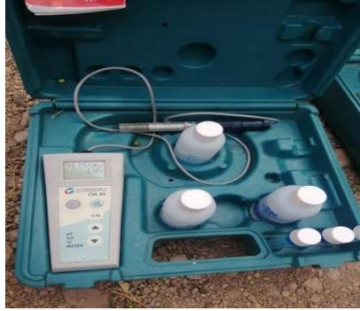
**Photo 9 : conductimètre utilisé pour mesurer la conductivité d'eau.**
