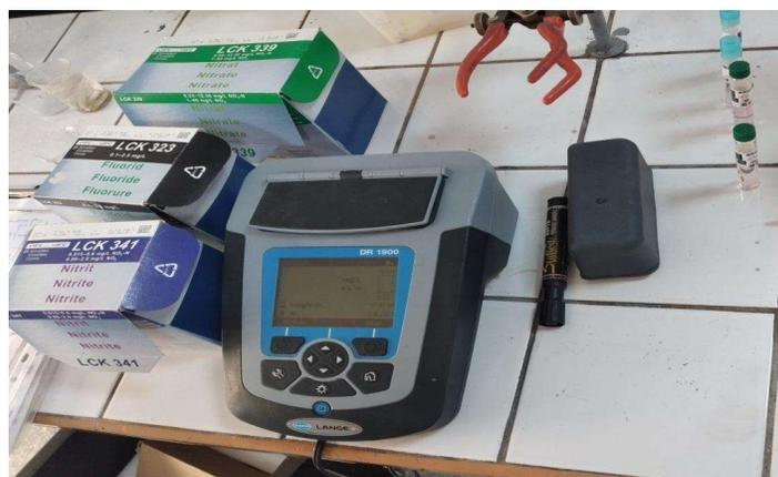
**Photo 13 :** Spectrophotomètre portable et les boîtes de kit-LCK.
