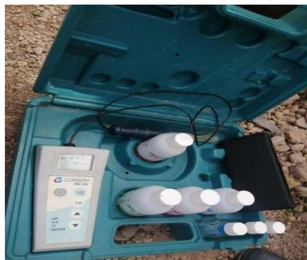
**Photo 8 :** pH mètre utiliser dans la mesure du potentielle d'hydrogène de l'eau.
