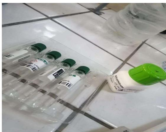
**Photo 14 :** Test en kit LCK- 339 (Nitrate) et la solution A.
