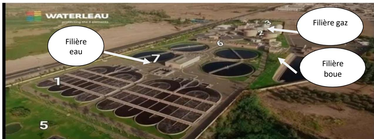
**Figure 8 :** les tranches de la station d'épuration de la ville de Marrakech. (WATERLEAU, 2014)
