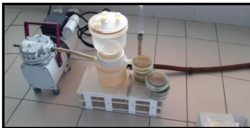
**Figure 37** : Principe de filtration sur membrane
