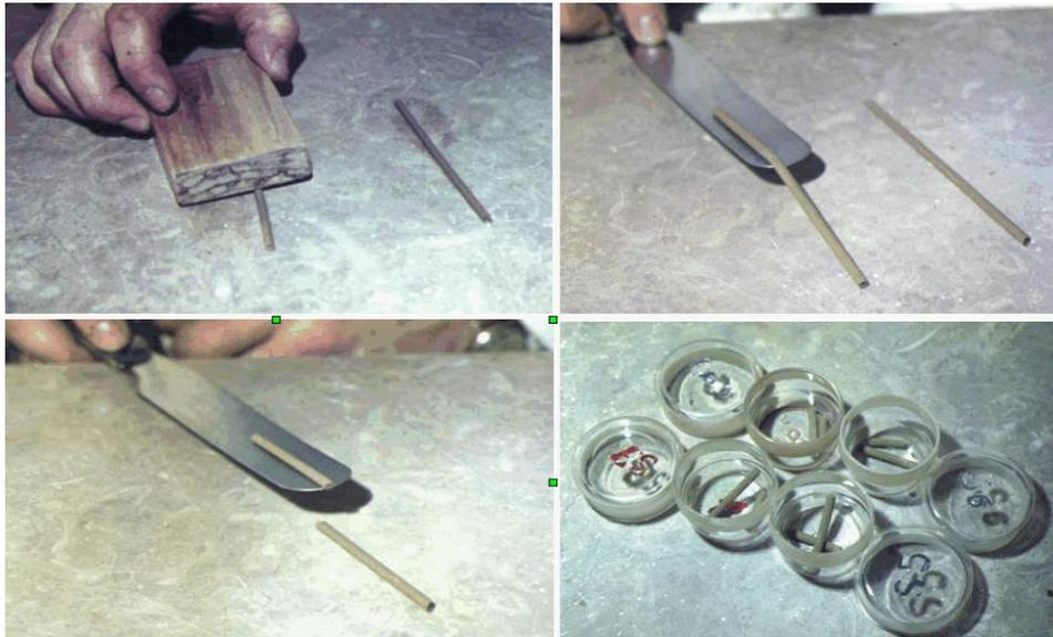
**Fig. 21 : Essai Atterberg, étapes de détermination de la limite de plasticité**
