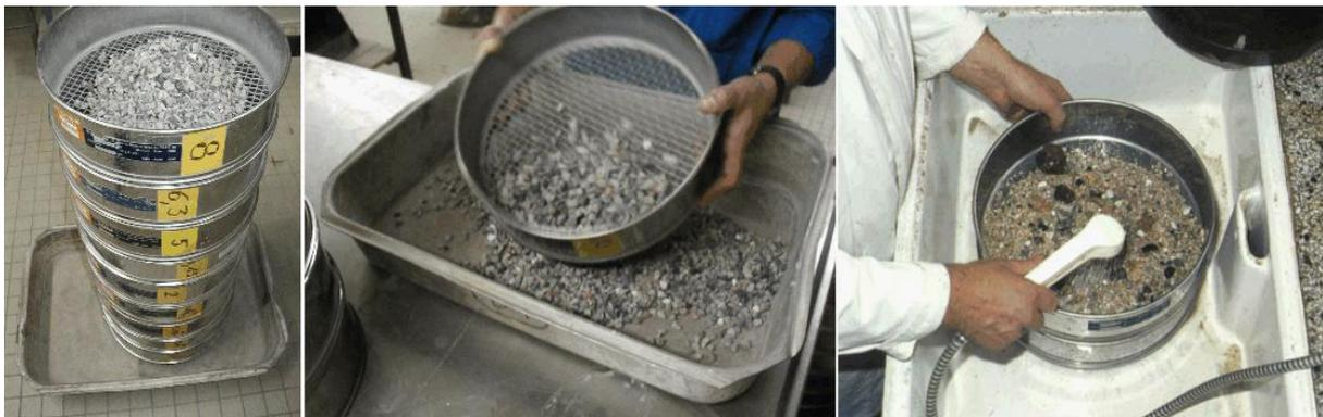
**Fig. 15: Equipement nécessaire pour une analyse granulométrique**
