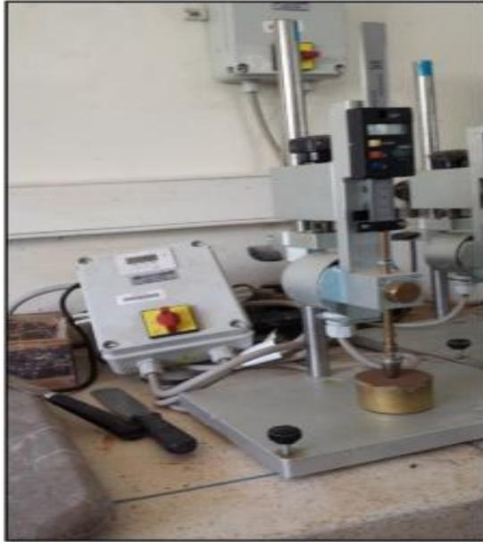
**Fig. 20 : Essai Atterberg, détermination de la limite de liquidité**
