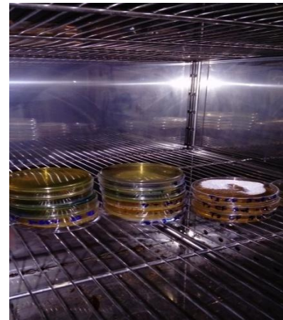
Incubation (CT et Streptocoques à 37°C Et CF à 44°C)
