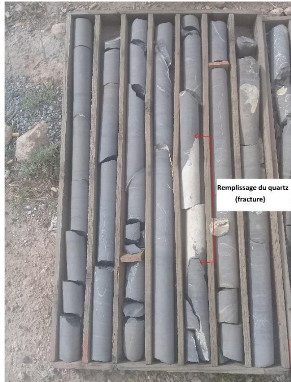
Figure 14 : remplissage de fracture par du quartz
