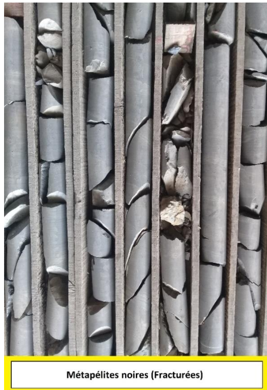
Figure 9: métopélites noires fracturées
