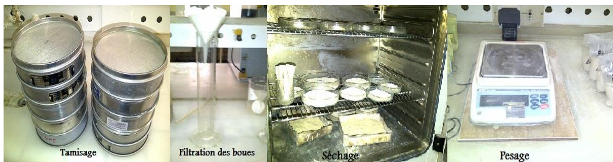
Photo 5: Matériels d'analyse granulométrique utilisée à la laverie de Safi
