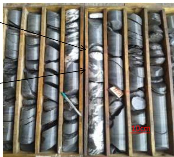
**Photo 5:** Injection de rhyolite avec des lambeaux de pélites et de quartz au sein des métapelites gréseuses.
