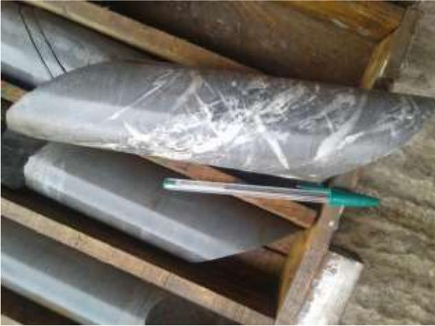
**Photo 21:** Deux générations des veines du quartz, des veines parallèles à la S1 les autres la recourent.
