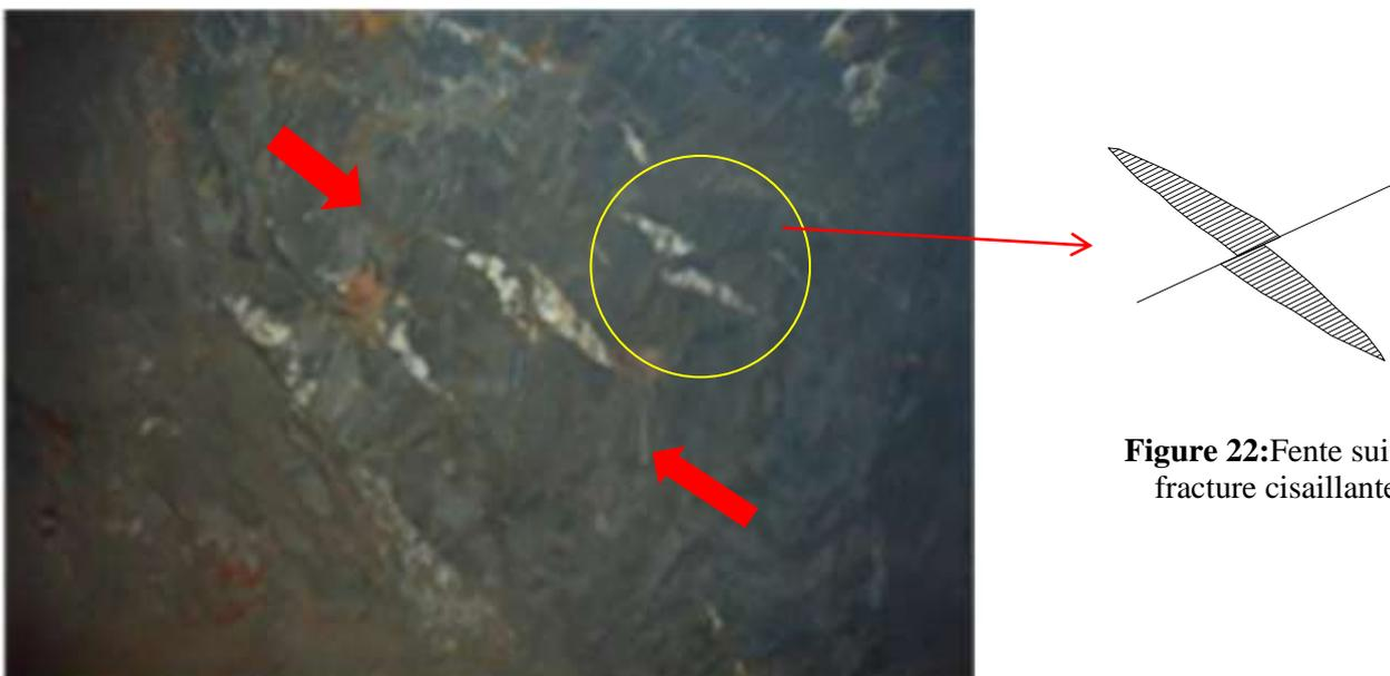
**Figure 22:**Fente suivie par une fracture cisailante dextre.
