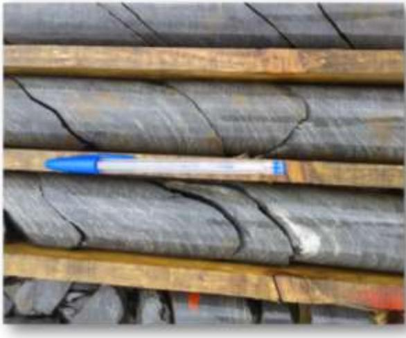
**Photo 27:** Les slumps dans les métapelites carbonatées.
