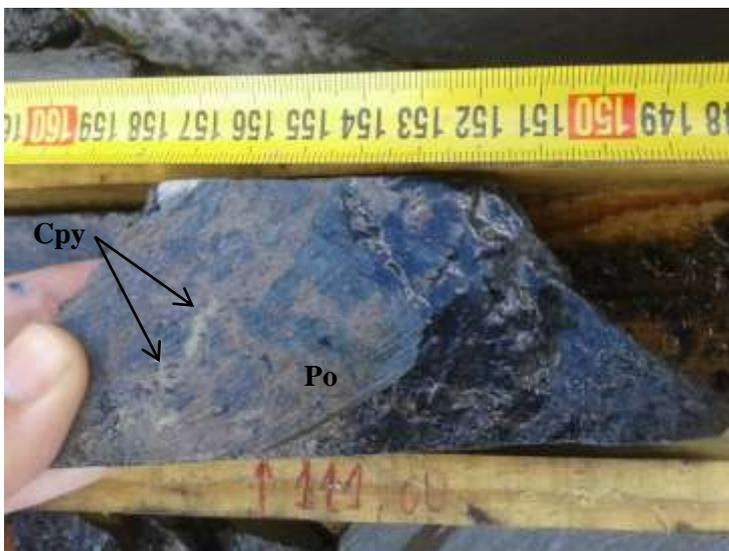
**Photo 10:** Dissémination des sulfures dans les tufs fins.
