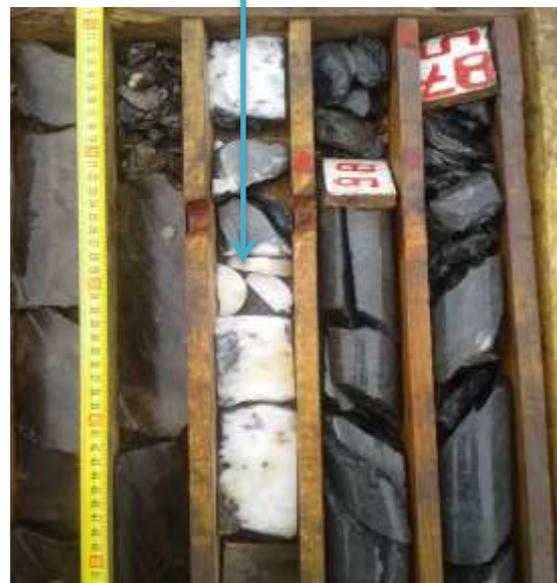
**Photo 25:** Faille à remplissage de quartz au contact mineraï-encaissant.
