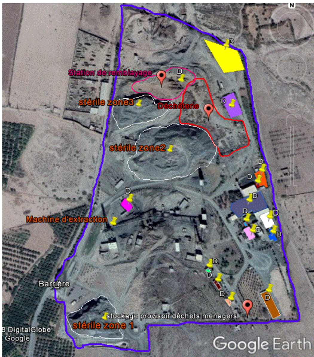
Figure 19 : Plan localisant les points générateurs de déchets du site DRAA SFAR.
