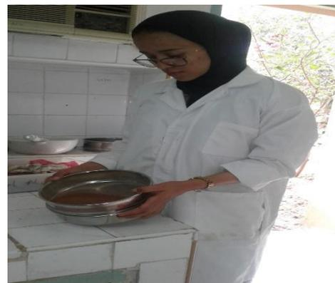
Photo 7 : Broyage et tamisage des échantillons de sol à 2 mm
