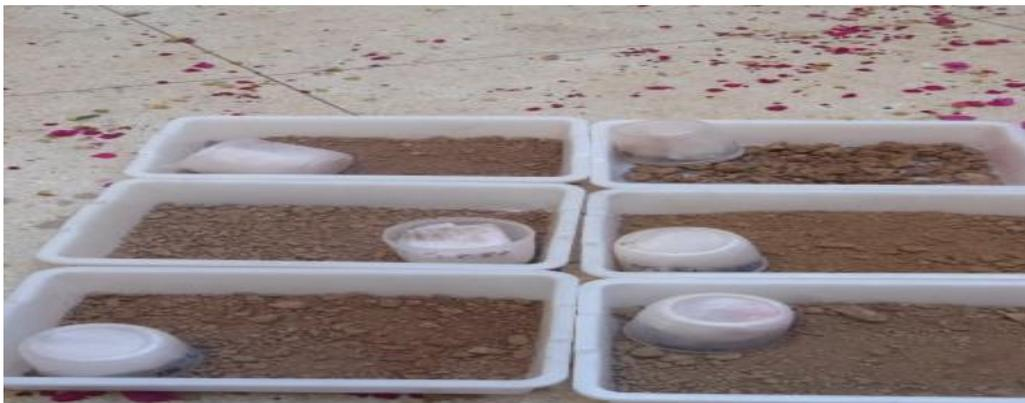
Photo 6 : Séchage des échantillons de sol à l'air ambiant.
