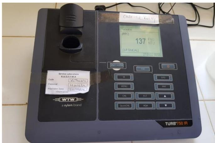
**Figure 17 : Turbidimètre utilisé lors de la mesure**
