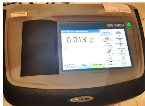
**Figure 25 : Spectrophotomètre**
