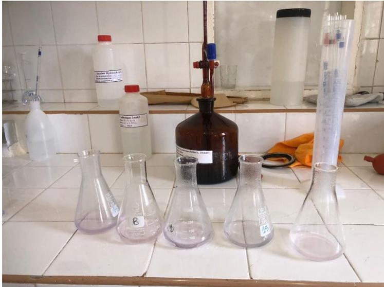
**Figure 20 : solutions d'oxidabilite apres le titrage**
