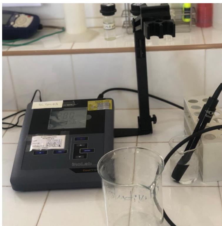
**Figure 16 : Conductimètre utilisé lors de la mesure**
