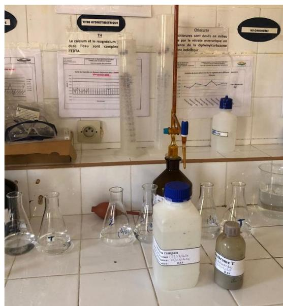
**Figure 23 : Réactifs utilisés dans détermination de la dureté**
