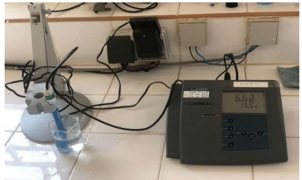
**Figure 15 : pH-mètre utilisé lors de la mesure**
