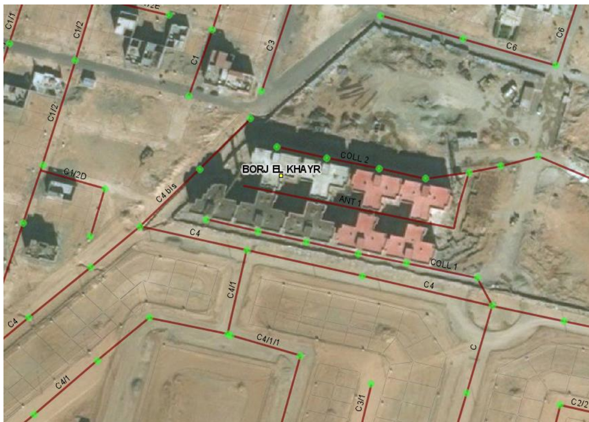
figure 34 : Schéma de la répartition du réseau des canalisations (Quartier borj al khayr vue dessus) échelle = 1/3000
