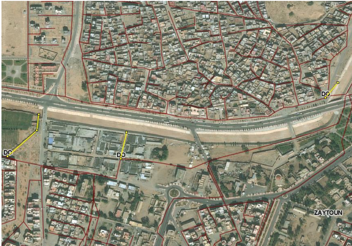
Figure 38 : Points de rejet des déversoirs d'orages à proximité de la population
