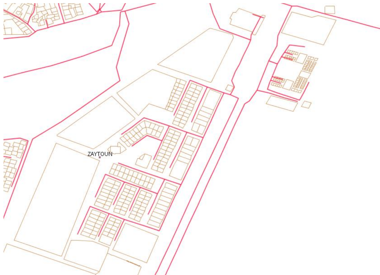
Figure 33 : Schéma de la répartition du réseau des canalisations (Quartier zaytoune vue dessus) échelle = 1/7000
