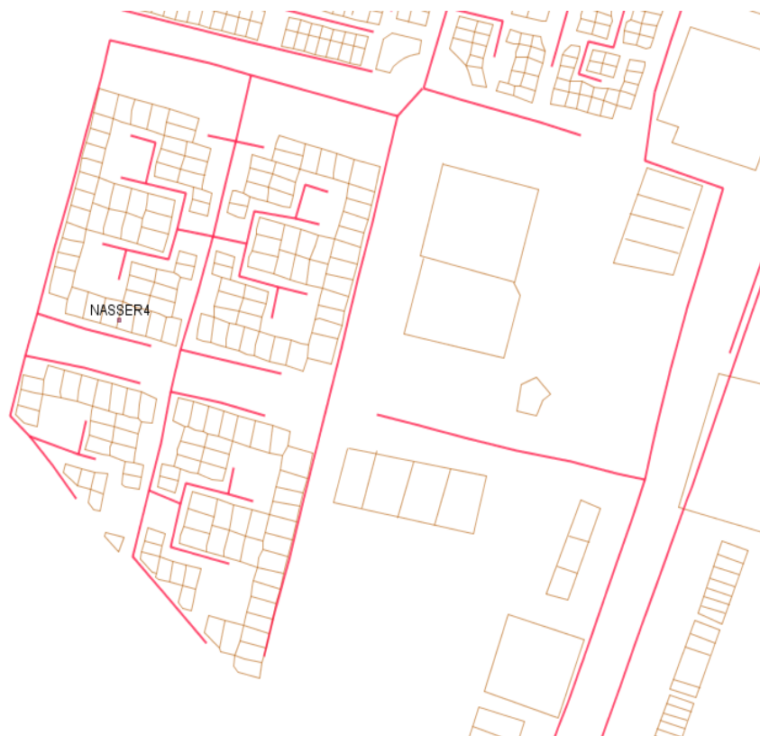
Figure 32 : Schéma de la répartition du réseau des canalisations (Quartier enasser 4 vue dessus) échelle = 1/5000
