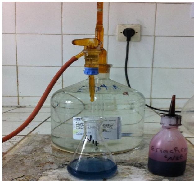
Figure12 : Dosage du Calcium, Magnésium et Sulfates par l'EDTA
