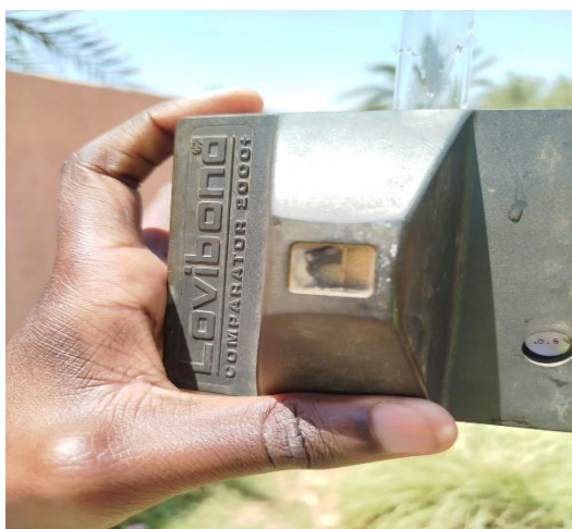
Figure 26 : Comparateur colorimétrique du chlore.
