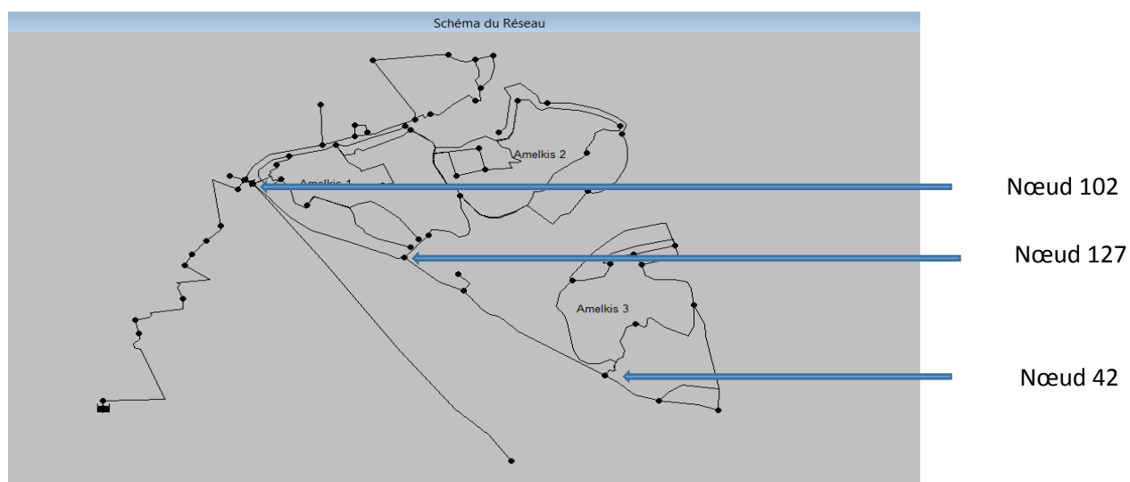
Figure 28 : Répartition des points de mesure du chlore sur le réseau étudié
