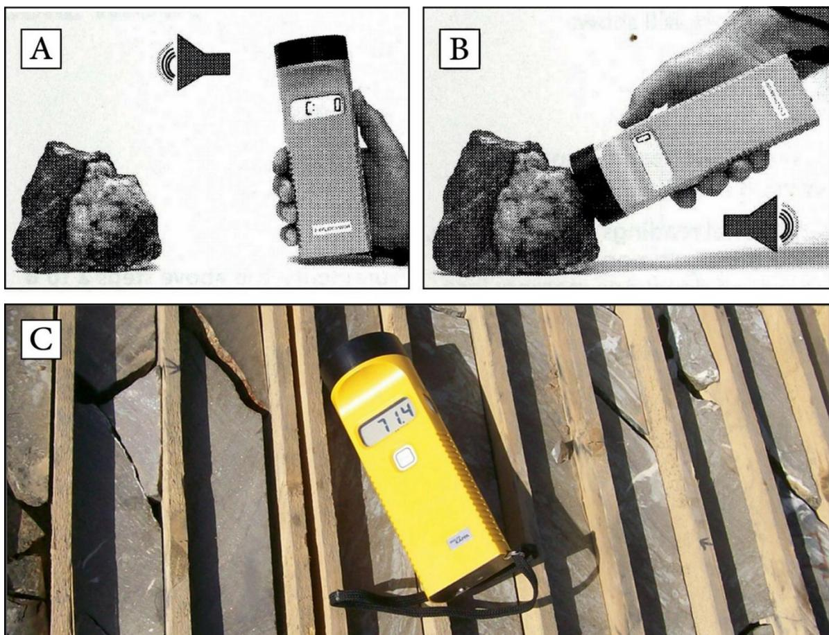
Figure III.3 : Mesure de la susceptibilité magnétique à l'aide d'un kappamètre (A : Initialisation, B : Lecture) ; C : Susceptibilimètre KT9 utilisé lors de la présente étude.
