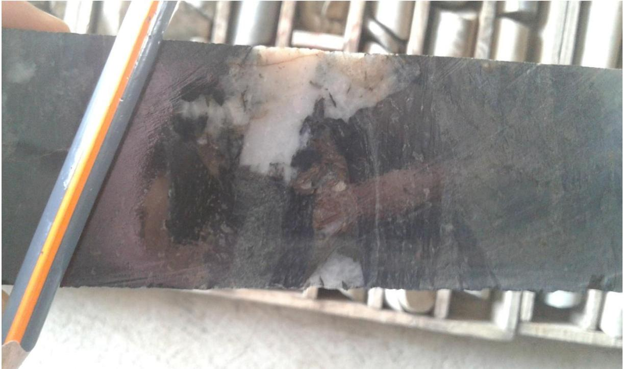
Figure II.1.1 : Pélites gréseux à pyrrhotite disséminée affectées de veines et veinules à quartz.
