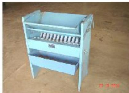
Photo 3: Echantillonneur pour gravier
