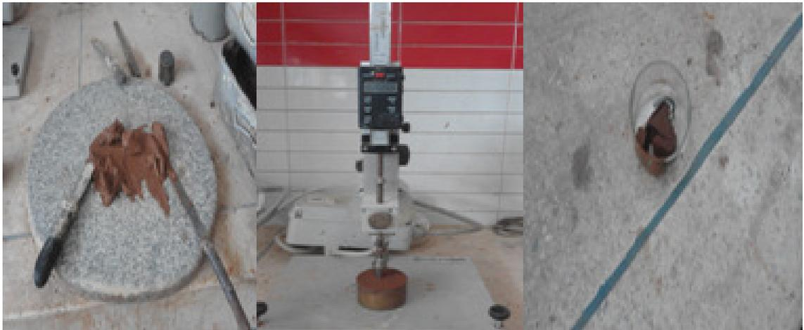
Photo 7:essai de pénétration à cône
