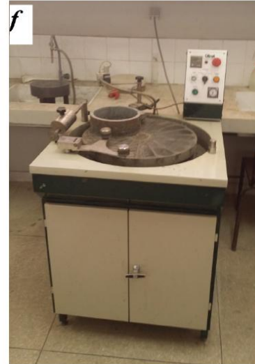
Planche I : (a) la scie diamantée, (b) la rectifieuse, (c) le tasseau, (d) collage à l'aide l'araldite (adhésif spéciale), (e) la microscie, (f) la rodeuse
