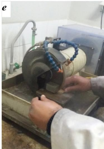
Planche I : (a) la scie diamantée, (b) la rectifieuse, (c) le tasseau, (d) collage à l'aide l'araldite (adhésif spéciale), (e) la microscie, (f) la rodeuse
