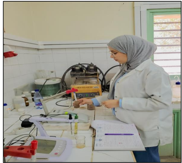
Photo 8 et 9 : Mesure de la conductivité du sol.
