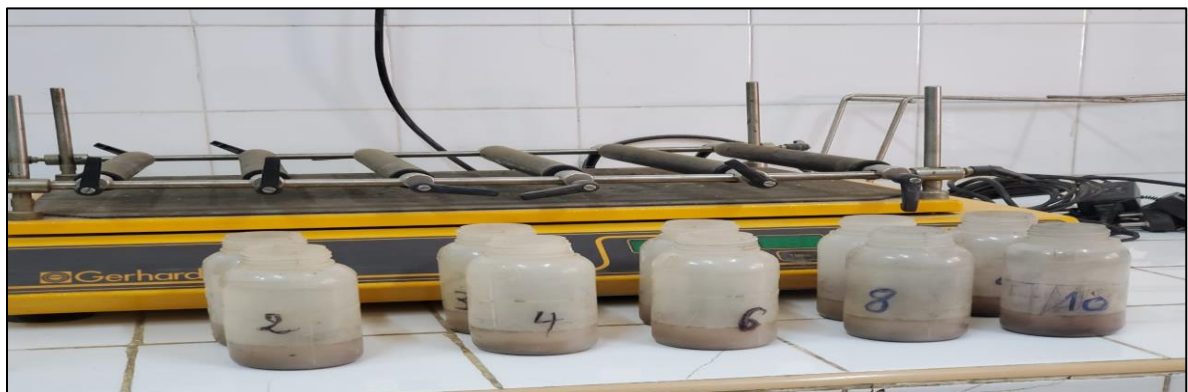
Photo 12 : Préparation des mélanges à l'aide de l'agitateur mécanique.
