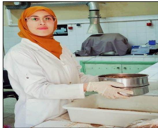
Photo 6 et 7 : Tamisage des échantillons de sol à 2 mm
