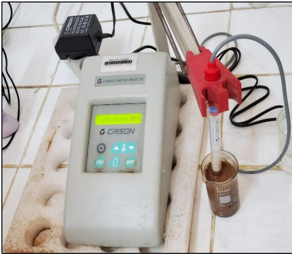
Photo 8 et 9 : Mesure de la conductivité du sol.
