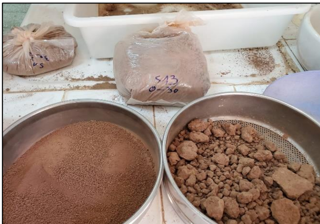
Photo 6 et 7 : Tamisage des échantillons de sol à 2 mm
