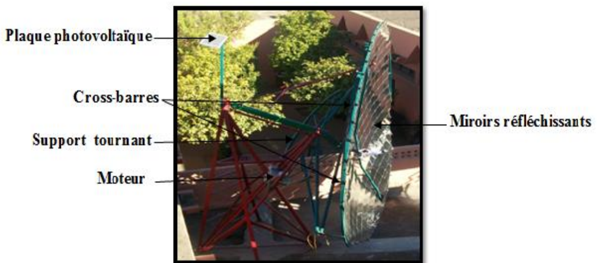
Figure 4 : Les différents constituants de la parabole solaire Scheffler
