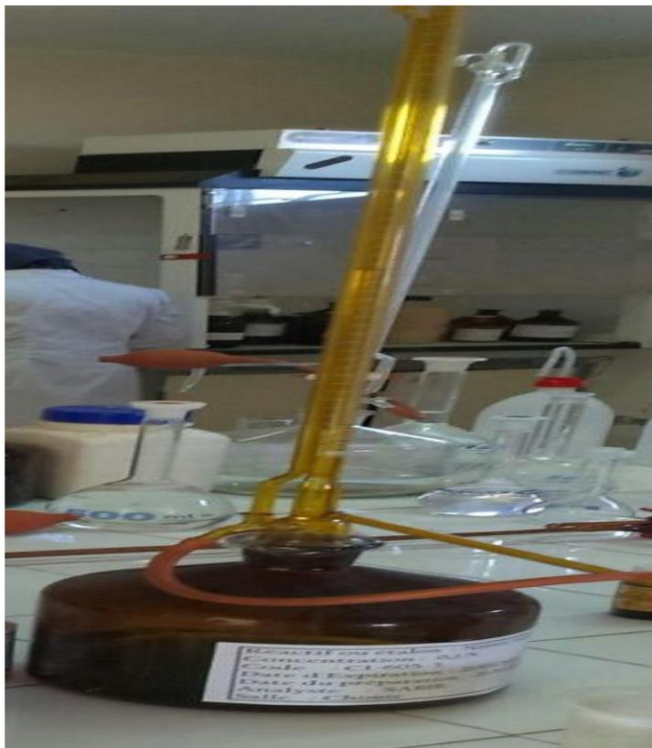
Figure 11 : Titrage par  $\text{KMnO}_4$
