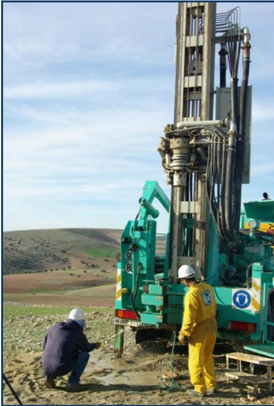
**Figure 31: Dispositif de mise en œuvre d'un carottage sismique.**
