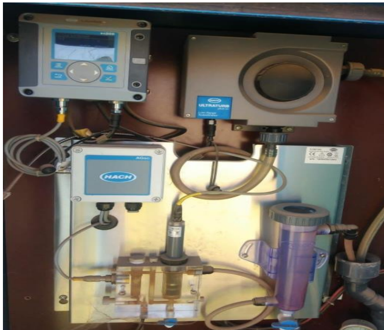
Figure 19: Le turbidimètre et le chloromètre du point de qualité de Arset Lmaach
