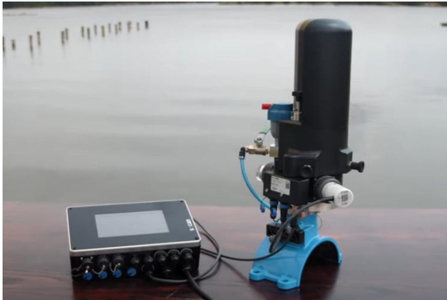
Figure 22: Sonde multiparamétrique de S::CAN (AQUATIC LIFE)
