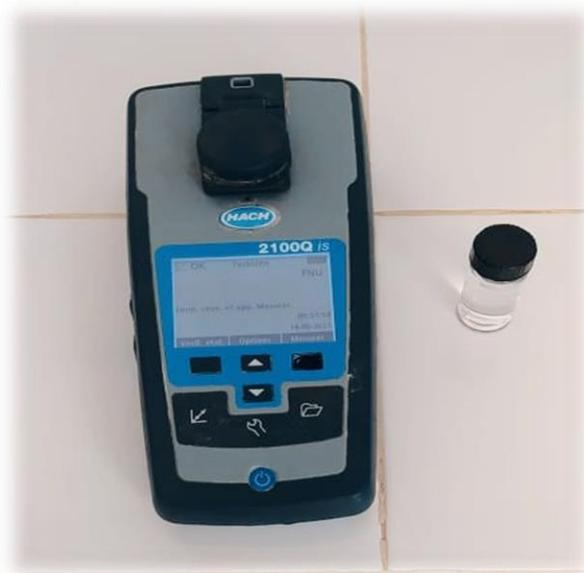
Figure 18 : turbidimètre
