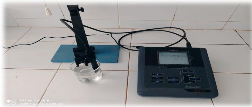
Figure 19 : conductivimètre
