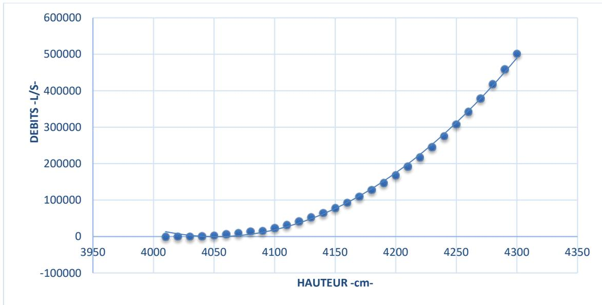
**Figure 19** : Courbe d'étalonnage de la station TAFERIAT (Batterie 3), date de validité : 29/05/2016 - 05/08/2016
