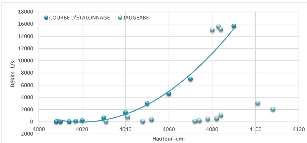
**Figure 17** : Courbe d'étalonnage n° 210 + Jaugeages de l'année hydrologique 2015/16 de la station TAFERIAT
