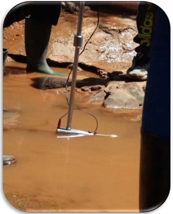
**Photo 2 :** Jaugeage au micro-moulinet
