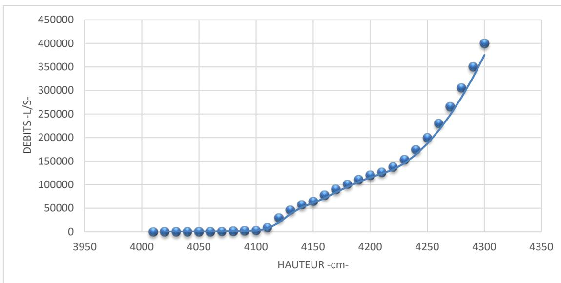
**Figure 18** : Courbe d'étalonnage de la station TAFERIAT (Batterie 3), date de validité : 04/09/2015 - 29/05/2016
