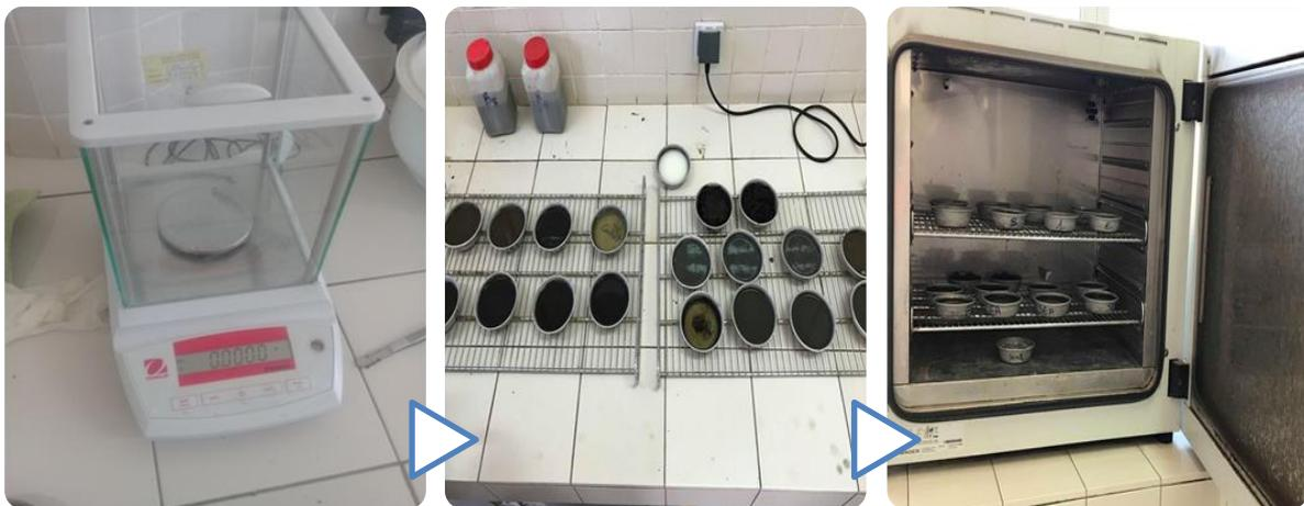
Photo 11: les étapes de mesure de la matière sèche
