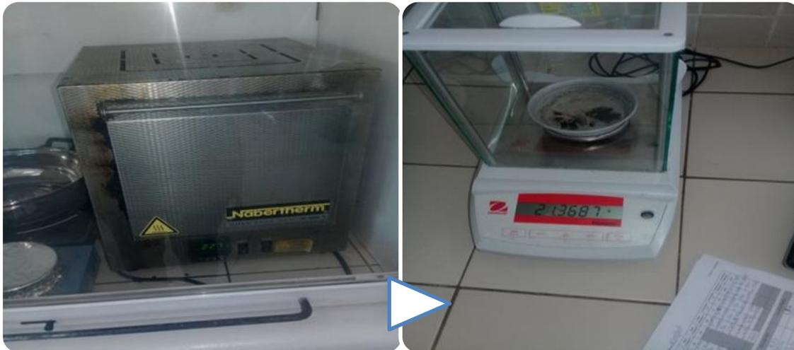
Photo 12: l'étuve à 550°C+ la mesure de la MSV
