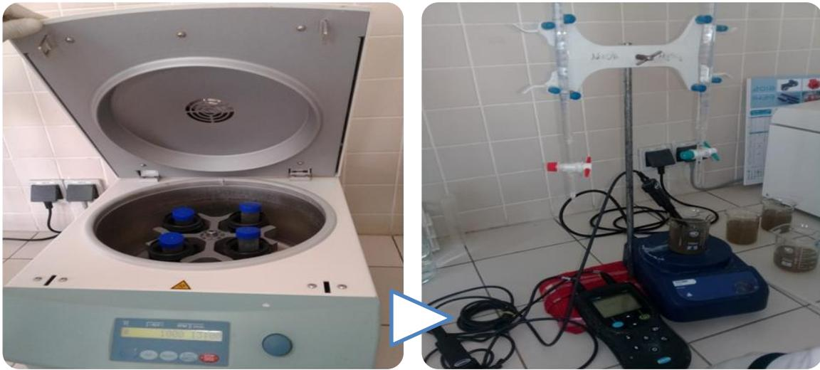
Photo 14: Centrifugeuse+ mesure d'alcalinité
