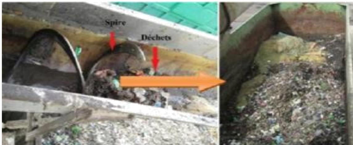
**Figure 4 : Evacuation de déchets vers les bennes de décharge**
