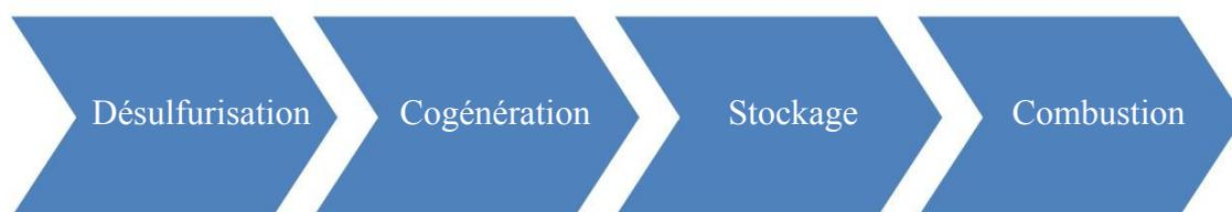
Du fait que le biogaz contient des taux plus ou moins élevés de soufre (H<sub>2</sub>S) qui a des effets nocifs tels que : la corrosion, l'endommagement des installations ...etc. Une partie du biogaz provenant des digesteurs va être comprimées puis réinjectées dans ces derniers, et l'autre partie va subir une désulfuration en éliminant le soufre par lavage. Le biogaz produit au sein de la station a une composition hétérogène, il comporte :
