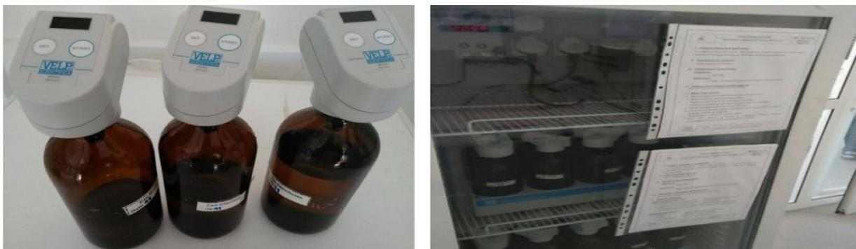
Figure 24 : Protocol expérimental de la DBO<sub>5</sub> (méthode manométrique)
