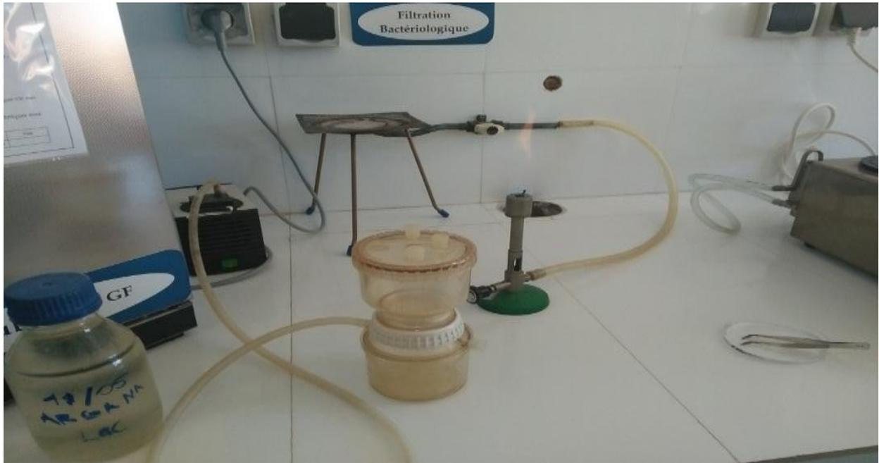
**Figure 26 : Dispositif de la filtration bactériologique**
