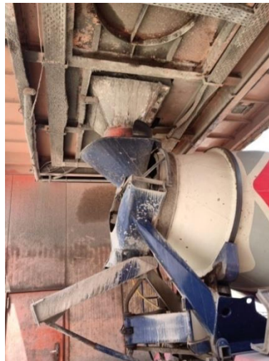
Figure31: La charge de béton frais
