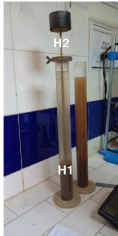
Figure21 : La distance mesurée par le piston
