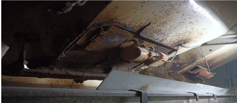
Figure 28 : Les trémies versent dans tapis peseur
