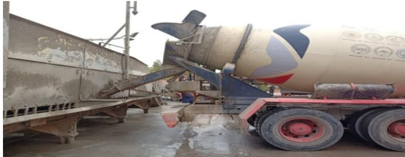
Figure 37 : Lavage de la citerne après livraison
