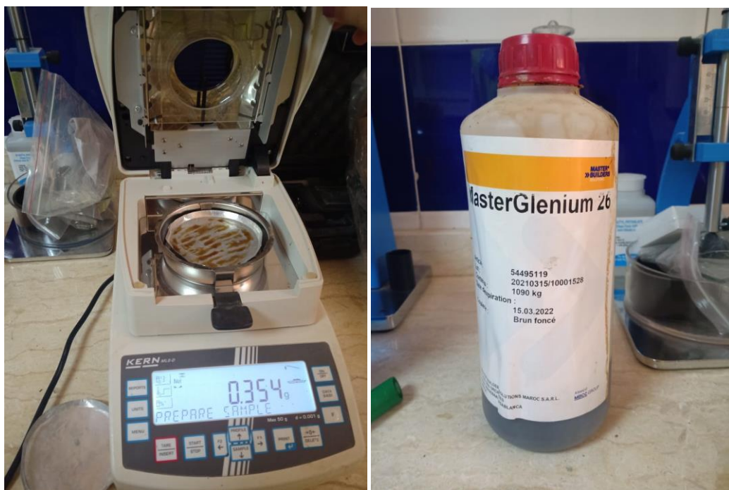
Figure 24 : L'étalement de l'adjuvant dans la cuvette de dessiccateur
