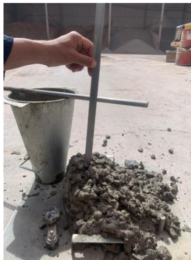
Figure 46 : lecture d'affaissement au cône d'Abrams
