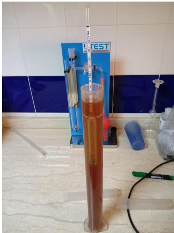
Figure26 : lecture de la densité par un densimètre
