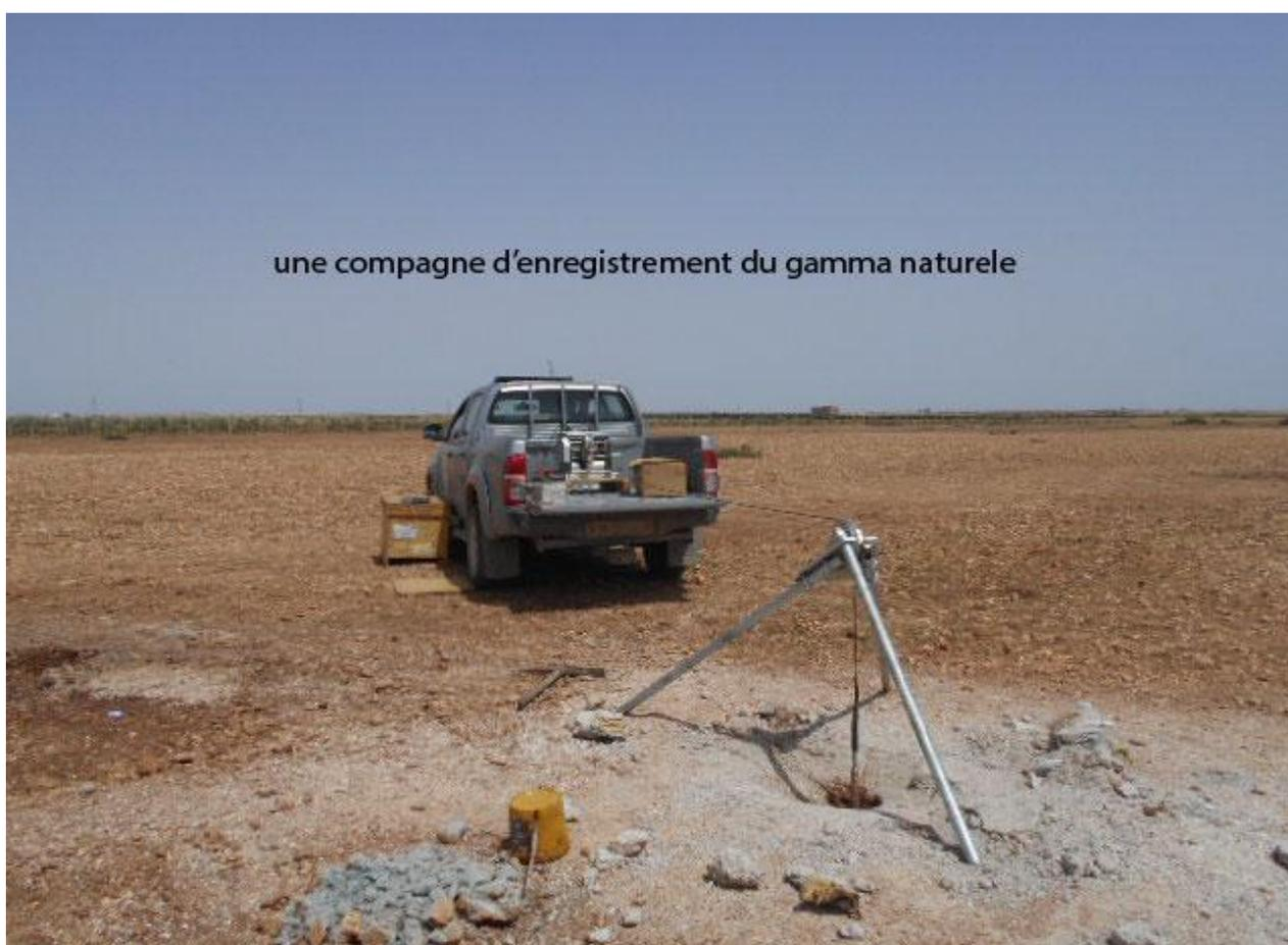
**Figure 12** : réalisation de la diagraphe gamma –ray du S40
