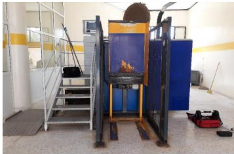
**Photo 5 :** Appareil de banalisation : SterilWave 440L
