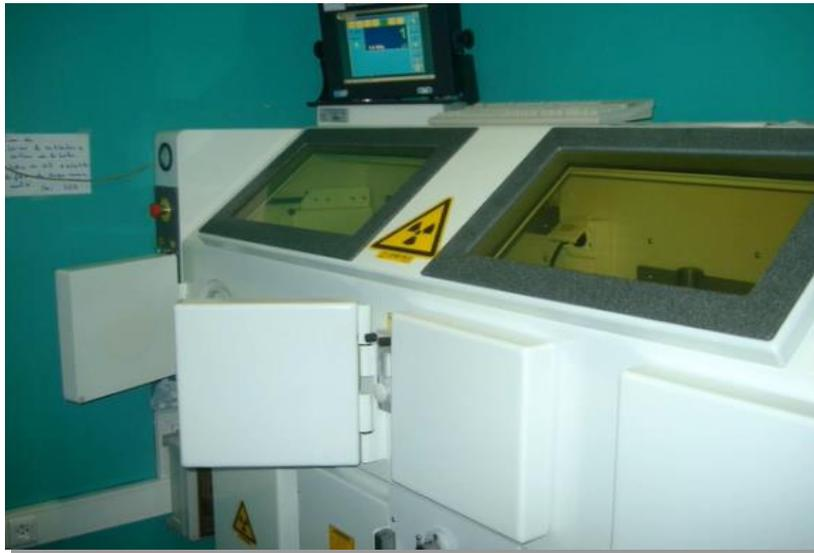
**Photo7** : enceinte de préparation des éléments radioactifs
