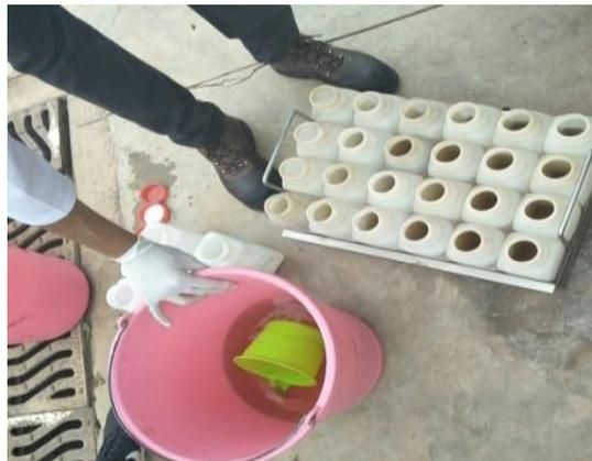
**Photo 14** : Prélèvement à l'entrée du traitement primaire
