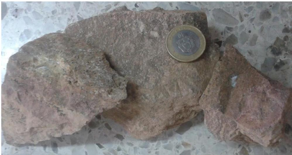
Figure 10 : Photo montrant un échantillon de calcaire magnésien (dolomitique) de la carrière M'zoudia
