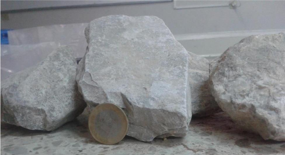
Figure 9: Photo montrant un échantillon de d'un calcaire pur de la carrière Mzoudia
