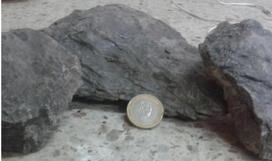
Figure12: Photo montrant un échantillon de schiste noir de la carrière M'zoudia
