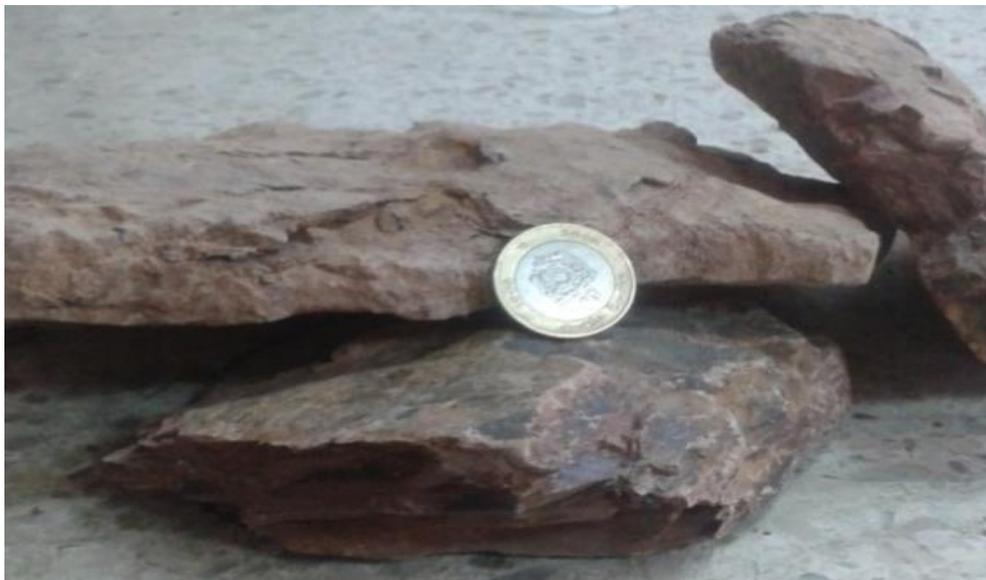
Figure13: Photo montrant un échantillon de schiste rouge de la carrière M'zoudia
