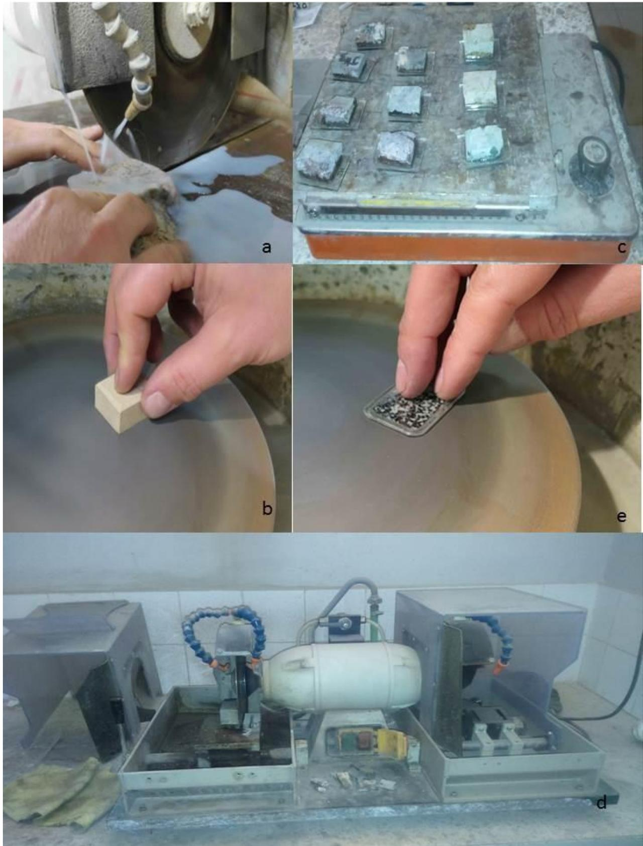
Planche2: *photos d'appareillage de fabrication des lames minces (prises au laboratoire des lames mince de la FSTG)*
