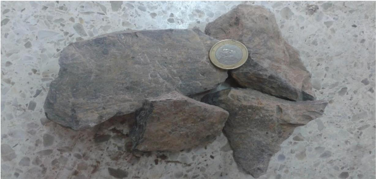
**Figure11:** Photo montrant un échantillon de calcaire marneux de la carrière M'zoudia
