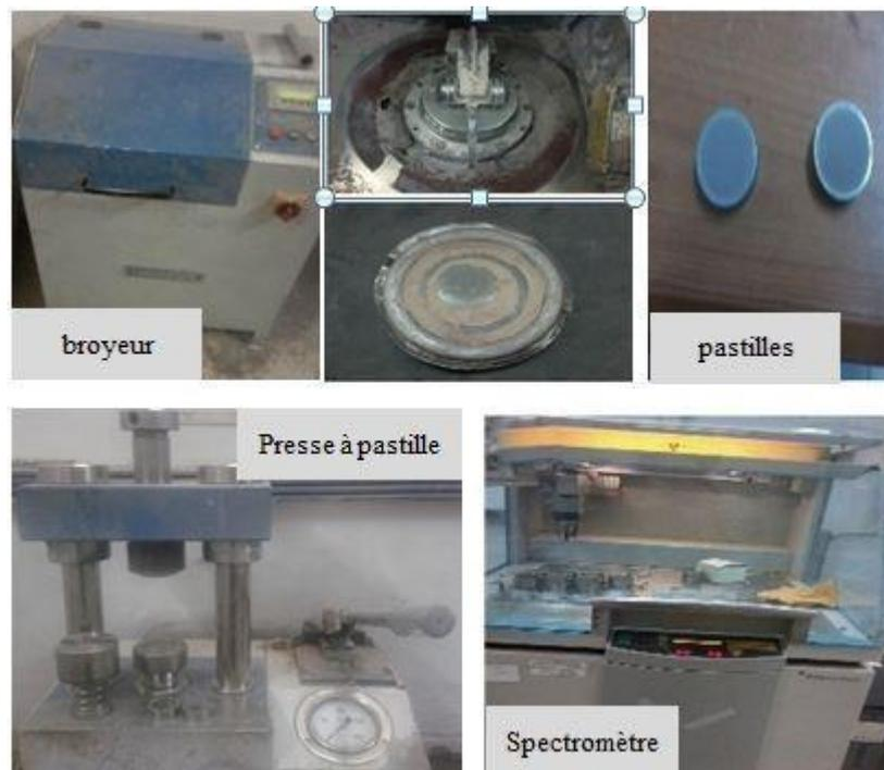
Planche1: Appareillages de la « fluorescence X »
