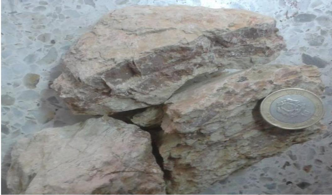
Figure14: Photo montrant un échantillon marne de la carrière de M'zoudia
