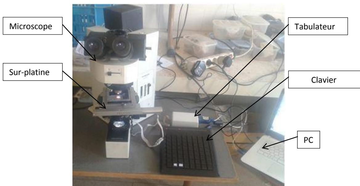
Figure 18: Appareillage de compteur des points
