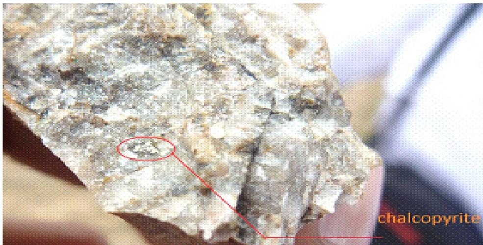
**Figure11 : La Chalcopryrite dans un filon Quartzo-carbonaté**
