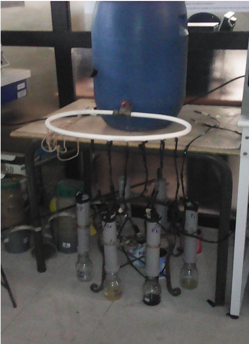
figure 6 : Tests en colonnes des matériaux utilisées dans le système MSL [CNEREE].
