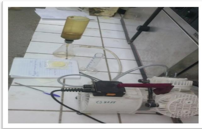
Photo 2 : Dispositif de filtration.
