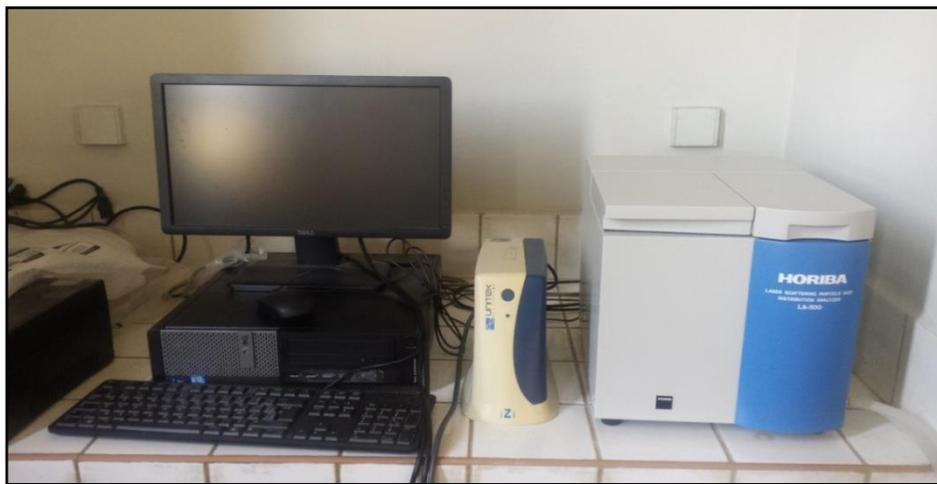
Figure 16: Granulomètre laser de type HORIBA
