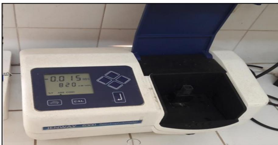
Figure 15: Spectrophotomètre utilisé pour calculer la densité optique
