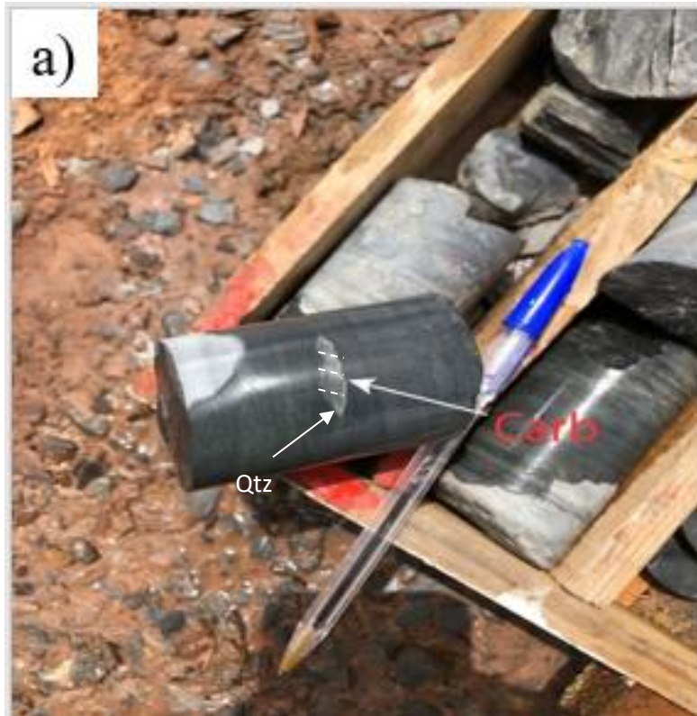
Figure 38 : a) Décalages des boudins de quartz-chlorite (Qtz) par des veinules millimétriques à carbonates (Carb) : DF544.
