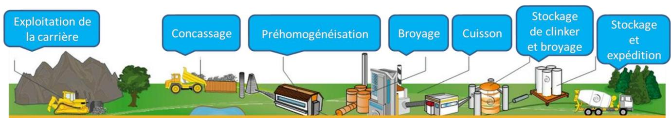
Figure 4: Procédures de fabrication de ciment
