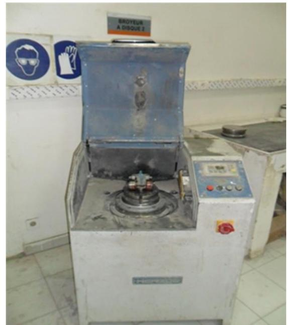
Figure22: Broyeur à disque(laboratoire de la société CIMAR)
