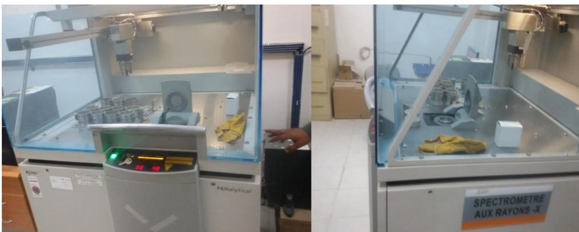
Figure24: Spectromètre aux rayons X(laboratoire de la société CIMAR)
