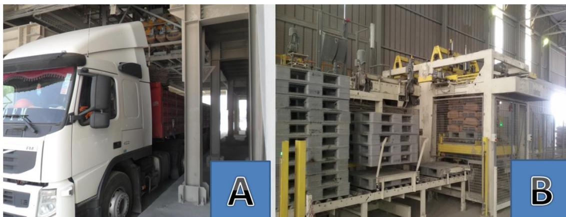
Figure 13: la livraison en sac (A) par méthode caricamate et méthode de palettiseur (B)
