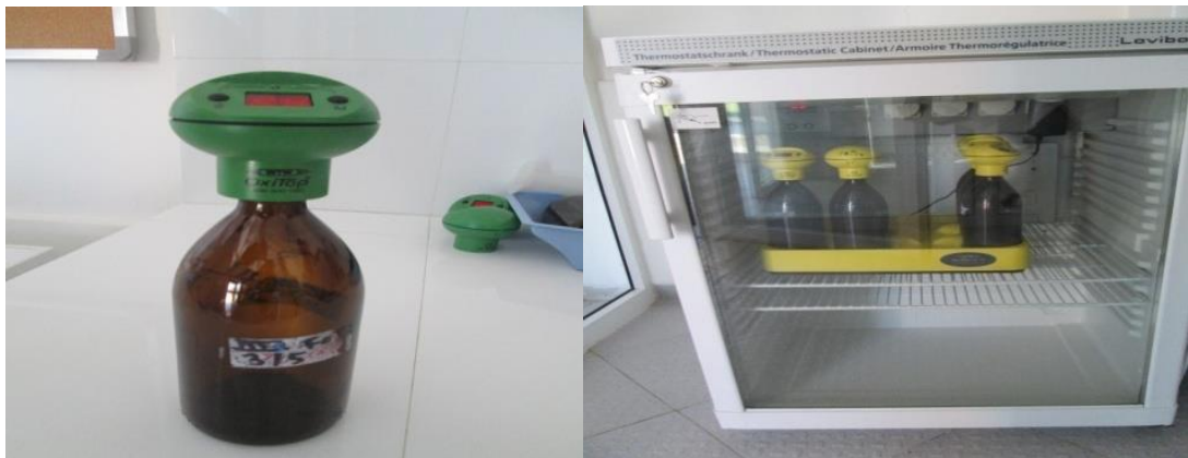
Figure 18: Le déroulement de la mesure de la DBO5 dans le laboratoire de la RADEEMA
