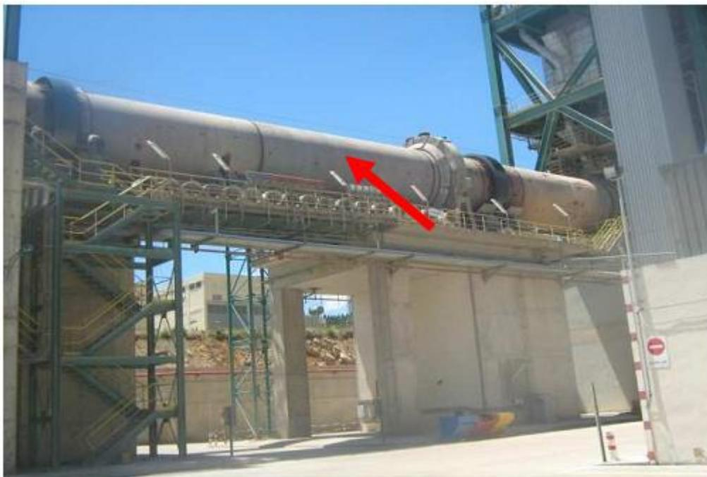
**Figure 12 : Photo d'un four rotatif**
