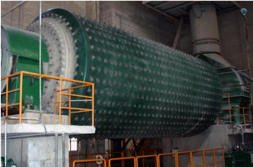
***Figure 13 : Broyeur à boulets***
