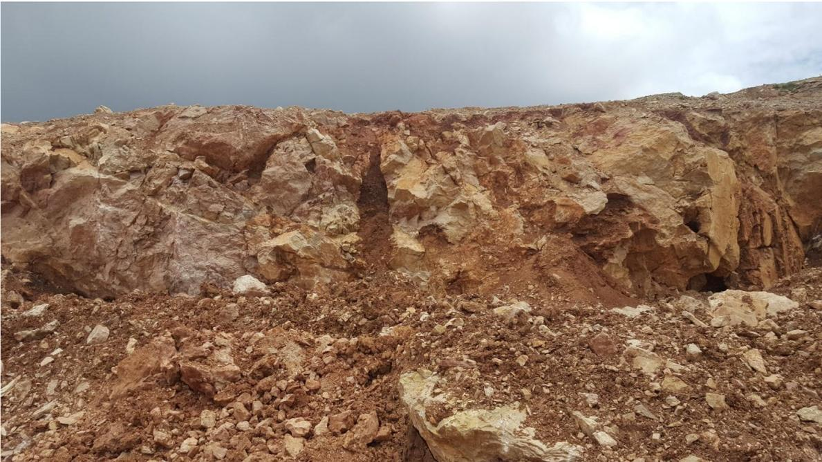
***Figure 21 : Photo d'un karst remplie par des argiles :***
