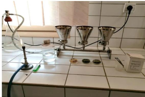
Figure 57 : Filtration sur membrane
