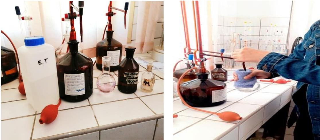
Figure 49 : Titration par le permanganate de potassium
