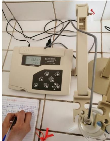
Figure 46 : Conductimètre
