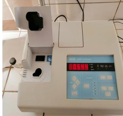
**Figure 47 : Turbidimètre**
