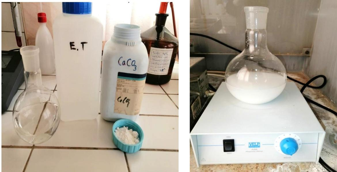
Figure 52 : Essai d'agressivité au marbre
