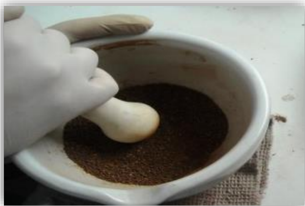
Photo 1 : broyage de l'échantillon
