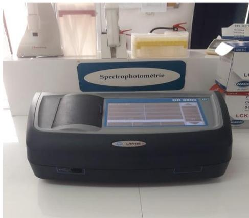
**Photo 1 : Spectrophotomètre**
