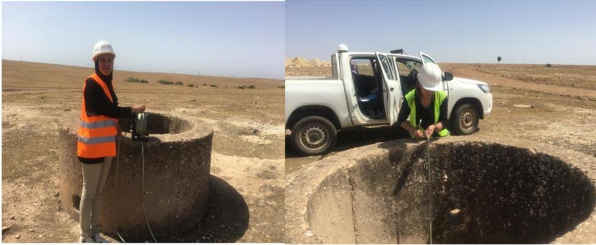
**Figure 6 :** Photographie montrant l'équipement utilisé pour le levé du niveau d'eau dans les puits OCP.
