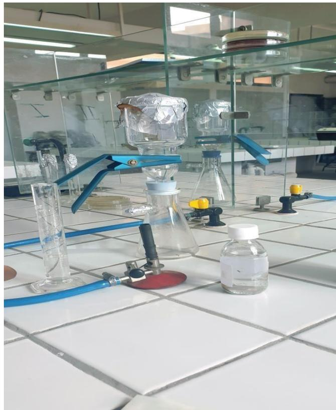
**Figure 12 : Appareil de filtration**
