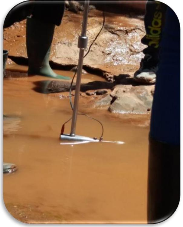
**Photo 2 :** Jaugeage au micro-moulinet
