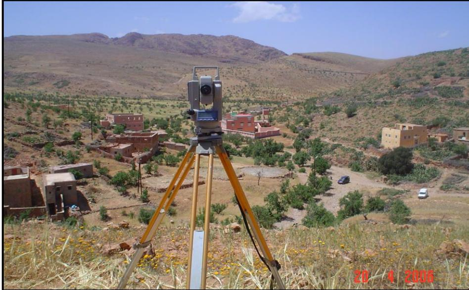
**Fig. 16 : Appareil topographique utilisée lors des relevés topographiques**
